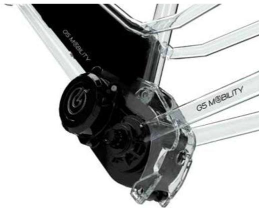
Il motore OLI Sport è molto silenzioso ed è inoltre estremamente generoso e progressivo nell'erogazione di tutta la sua potenza. La sua coppia di 85 Nm è a disposizione del cliente per restituire un feeling di guida davvero unico.
